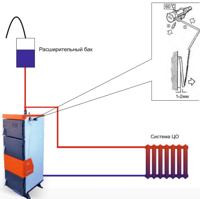
В комплект поставки входит регулятор тяги первичного воздуха, который служит для изменения подачи воздуха в зону горения. При изменении интенсивности горения топлива, изменяется температура теплоносителя. Монтаж регулятора тяги.
